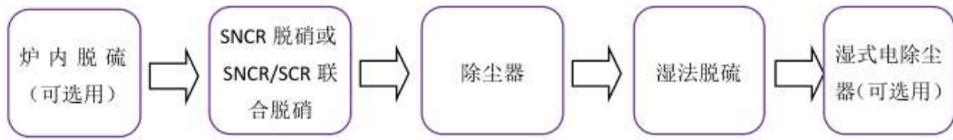
图 2 超低排放工艺流程 2 (循环流化床锅炉)
